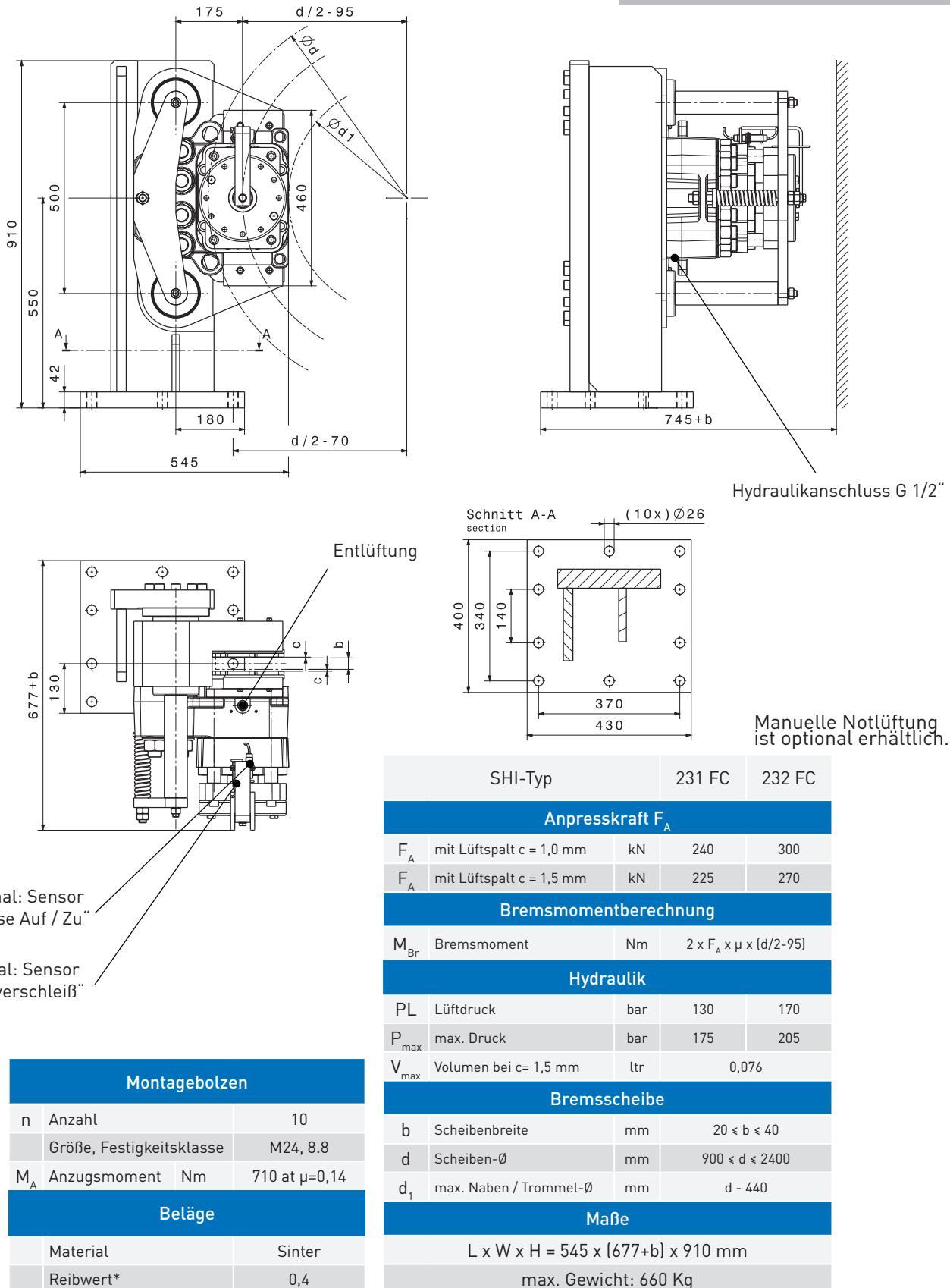
\*Mittlerer Reibwert bei Standard-Materialpaarung und einer Umfangsgeschwindigkeit bis 15 m/s
