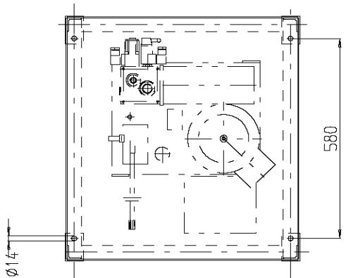
Schutzaube für Hydraulikaggregat V3 mit abnehmbarer Frontplatte sowie rückseitigem Inspektionsfenster
